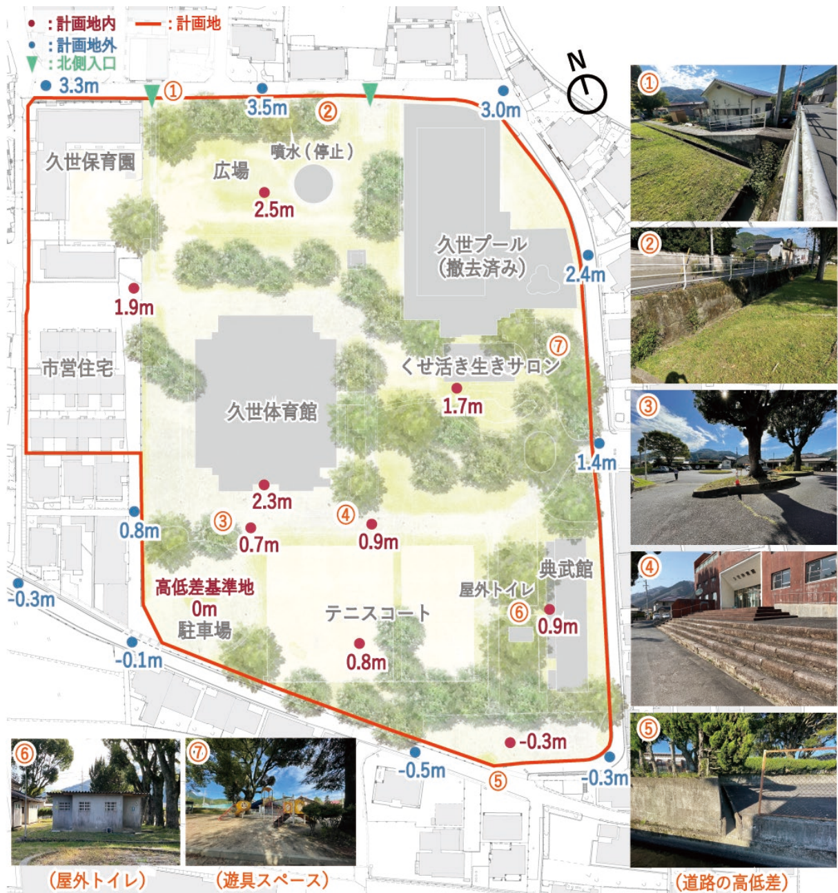
【計画地内の段差・擁壁】
