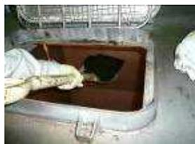
製品ホッパ上部のぞき窓より柄の長いスコップなどで汚泥肥料1ロットの表層のランダムな位置から採取
