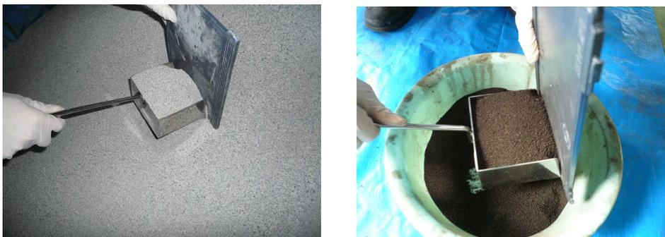
図9 インクリメント採取の例
