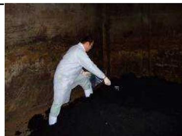
堆積された汚泥肥料の表層から4個インクリメント採取
