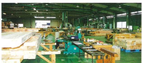
コンピュータ制御によるプレカットの生産ライン
