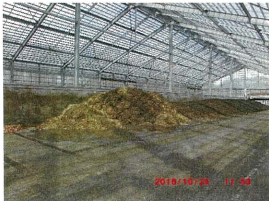
堆肥化プラント。精製段階で出たワラ類などは、攪拌して自然乾燥させ肥料として販売する。
