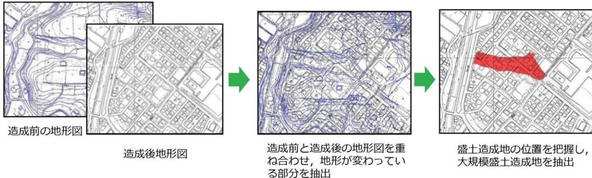
国土交通省「大規模盛土造成地の滑動崩落対策推進ガイドライン及び同解説」より
