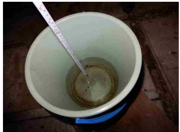
写真 17 調査時、約 4 cm の雨水が溜まっていた
