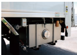
③汚水タンク
