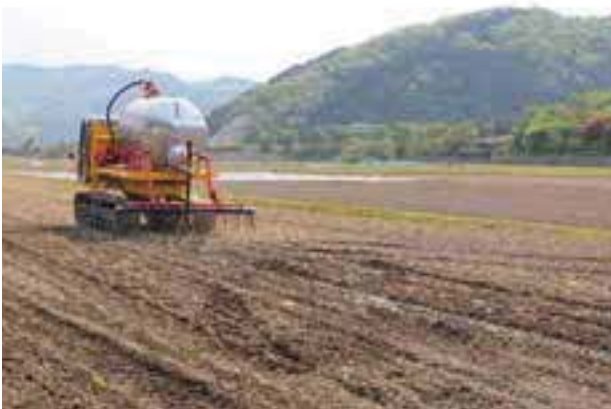
約2haの圃場に専用車でバイオ液肥を散布
