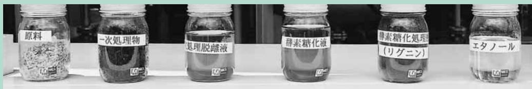
■プラントでは、化学反応で木材片を糖に変え、さらに酵母菌を利用し発酵させて、リグニン(樹脂)と無色透明のエタノールに分離します。リグニンはプラント内の燃料として利用されるため、最終的な排出物は水のみとなります。
