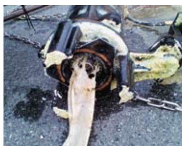
タオルが絡まり停止したポンプ
